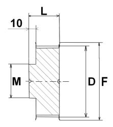
Poulies dentées standard (en orange dans le tableau) en aluminium, équipées de flasques jusqu'à 40 dents incluses. Délai de livraison de quelques jours.
