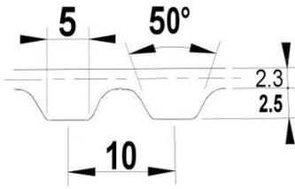
Courroie synchrone à denture optimisée, polyuréthane/câbles acier haute performance. Pour mouvement linéaire, charge moyenne à lourde. Grande stabilité, grande précision de positionnement.
