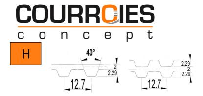
Courroie synchrone à denture trapézoïdale svt DIN 5296, polyuréthane/câbles acier, pas impérial =12.7 mm. Transmission de moyenne puissance, convoyage, mouvement linéaire pour charge moyenne. Bonne flexibilité, petits diamètres de poulies.
